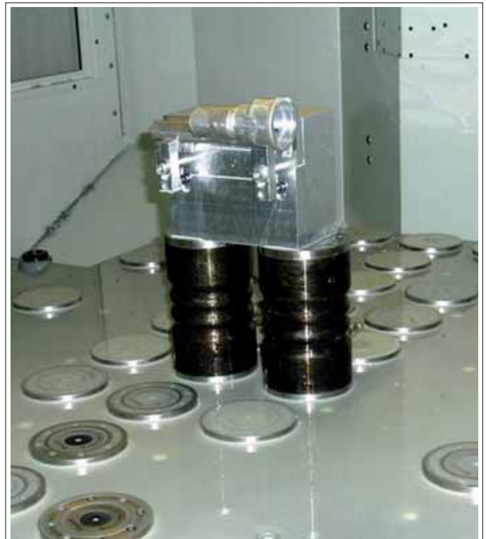
Um die Vorteile von Nullpunktspannsystemen optimal auszunutzen, werden kleine und unterschiedliche Stichmaße gewählt.
