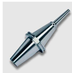
Das Power Mini Shrink Chuck ist ideal für die 5-Achs-Bearbeitung im Formenbau und in der Medizintechnik. An der Spitze sind sie extrem schlank, wie von unseren Mini Shrink Chucks gewohnt. An der Basis sind sie aber verstärkt. Dadurch ist auch bei langer Auskraglänge eine effiziente Fräsbearbeitung mit angestelltem Werkzeug möglich.
