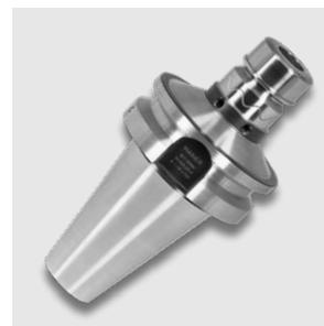
Das High Precision Collet Chuck ist das Spannzangenfutter für höchste Zerspanleistung. Das optimierte Design mit verbesserter Bauweise und speziell beschichteter Glattmutter verbindet hohe Steifigkeit mit Schwingungsdämpfung und Geräuschreduzierung. Das schont Maschine, Spindel und Werkzeug.
