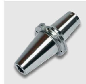
**Das Power Shrink Chuck ist das Schrumpffutter für höchste Zerspanleistung bei der Hochgeschwindigkeitsbearbeitung. Das optimierte Design verbindet hohe Steifigkeit mit Schwingungsdämpfung. Das schont Maschine, Spindel und Werkzeug.**
