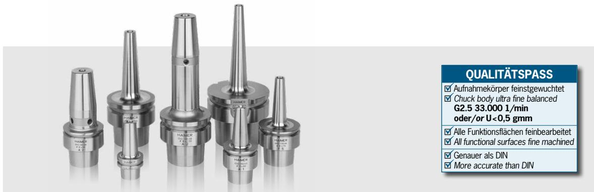
HAIMER bietet Ihnen die Möglichkeit Ultra-Präzisionsschrumpffutter mit einer Rundlaufgenauigkeit von < 1 µm auszuliefern. Die Ultra-Präzisionsschrumpffutter mit zusätzlicher Feinstwuchtung sind perfekt für Ultra-Hochgeschwindigkeitsbearbeitungs- und Hochpräzisionsfräszentren geeignet, um noch bessere Oberflächen erzielen zu können.
