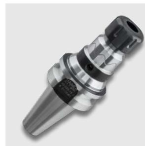
Das Power Collet Chuck ist das Spannzangenfutter für höchste Zerspanleistung bei der Hochgeschwindigkeitsbearbeitung. Das optimierte Design mit verbesserter Bauweise verbindet hohe Steifigkeit mit Schwingungsdämpfung. Das schont Maschine, Spindel und Werkzeug. Das universelle Power Collet Chuck ist ein einzigartiges Hochleistungsspannzangenfutter, das auch mit Standard-Spannzangen eingesetzt werden kann.
